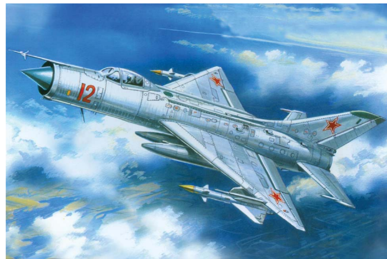
Истребитель-перехватчик Су-11. Максимальная скорость 2 340 км/ч на высоте 12 км. Допустимая высота полета 18 км. Вооружение: ракеты «воздух-воздух».
