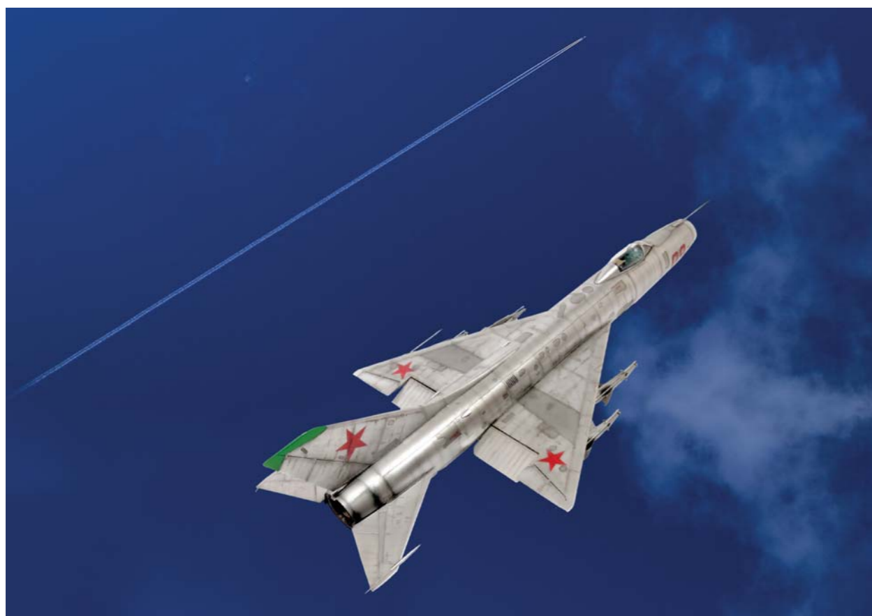
Первый советский сверхзвуковой перехватчик Су-9 (опытный Т-3 и Т-43). Максимальная скорость 2 230 км/ч на высоте 12 км. Допустимая высота полета - 20 км. Длина разбега 1,2 км. Вооружение: ракеты воздух-воздух.
