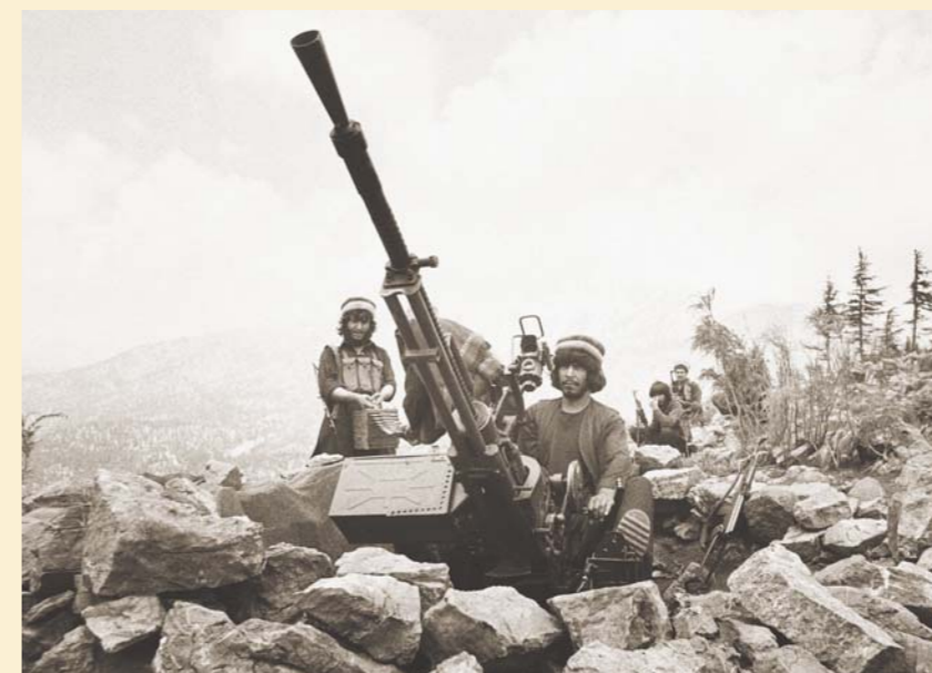
14,5 мм зенитная горная установка моджахедов «Зикроят» (Тип 75-1 –облегченный вариант советской ЗГУ-1 китайского производства)
